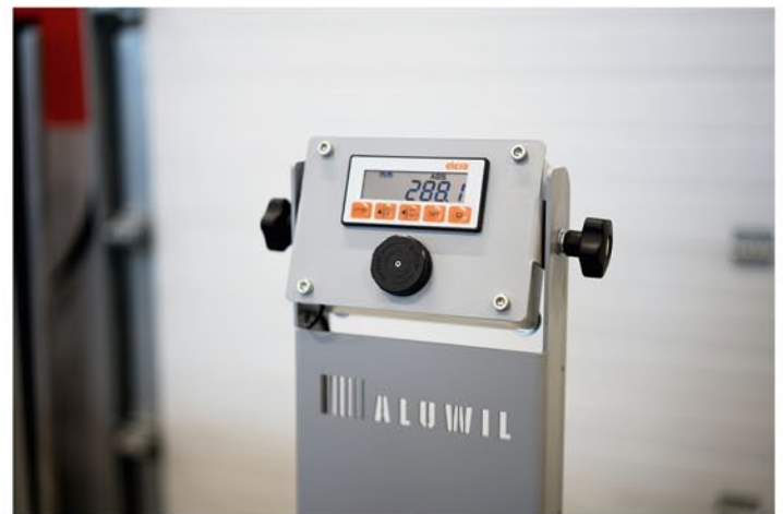
Rys. 3. Wyświetlacz wskaźnika położenia z czujnikiem magnetycznym MPI-15 zabudowany w panelu. Regulację ustawienia kąta zapewniają pokrętki VCT; panel zapewnia również wygodny dostęp do baterii zasilającej układ pomiarowy
