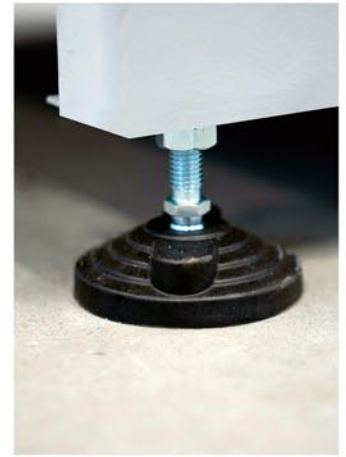
Rys. 7. Zarówno maszyna, jak i przenośniki rolkowe wyposażone są w stopy wahlive LV.F, umożliwiające zakotwienie do podłoża
