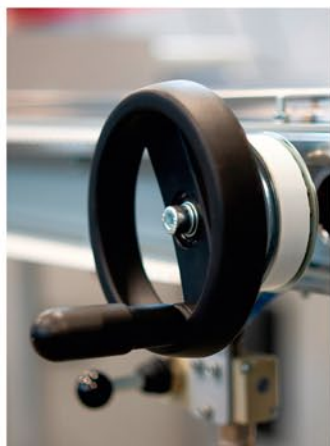
Rys. 5. Zderzak pomiarowy napędzany paskiem zębatym za pośrednictwem koła ręcznego VRTP+I
