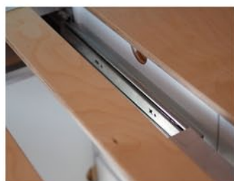
Rys. 10. Prowadnica teleskopowa serii GN 1440 zamocowana do wysuwanego modułu łóżka.
