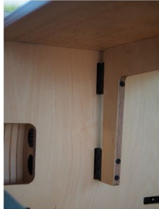
Rys. 8. Zawiasy serii CFF zamocowane do nogi od stołu.
