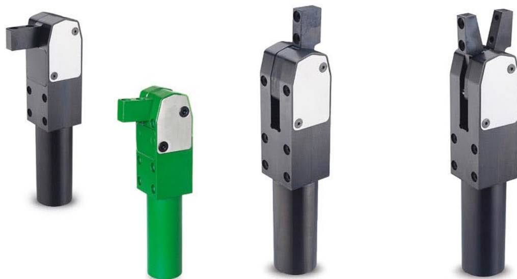
Rys. 1. Dociskacze spawalnicze w pozycjach zablokowanych: od lewej seria GN 864 (odmiana zielona - z powłoką teflonową, zapobiegająca przyleganiu odprysków spawalniczych), w środku seria GN 865, a z prawej strony seria GN 866 umożliwiająca blokowanie jednocześnie w dwóch kierunkach.
