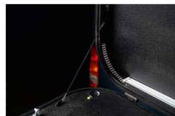
Rys. 11. Linka zabezpieczająca GN 111.2.
