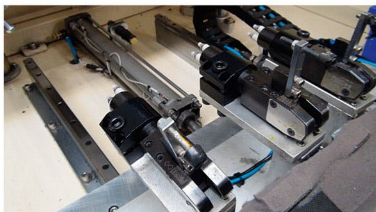
Rys. 3. Dociskacze spawalnicze GN 865 w urządzeniu zgrzewającym firmy Koam Sp. z o.o. (branża automotive).
