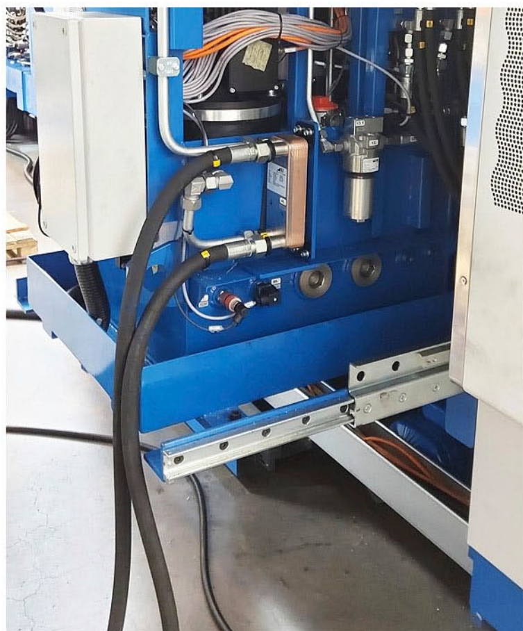
Rys. 3. Ciężkie prowadnice GN 2406 zastosowane do wysuwu agregatu hydraulicznego w tokarce UGE 180 N.
